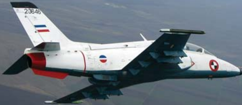
У односу на основну варијанту авиона, на Г-4М, у први мах упадају у очи лансери за ракете Р-60 смештени на крајевима крила
